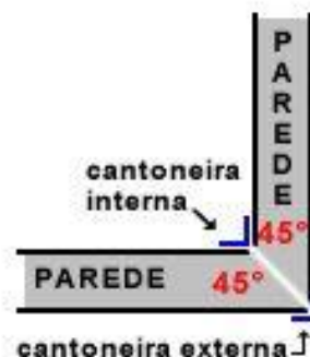
Detalhe 2 junção de canto a 45°
