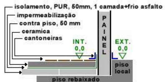
Detalhe 6 isolamento de piso tradicional - nivelado
