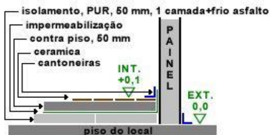
Detalhe 5 isolamento de piso tradicional - elevado
